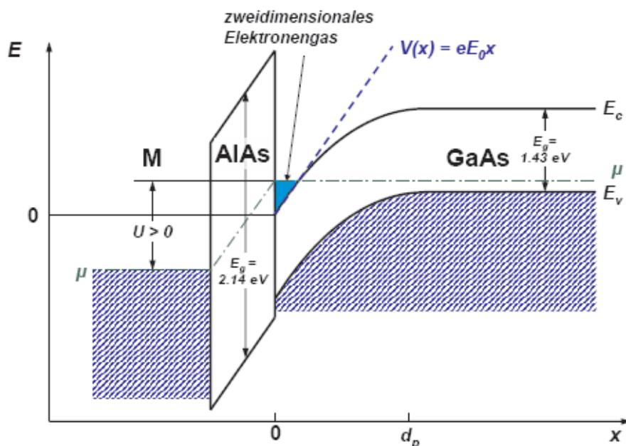
Abbildung 1: Zweidimensionales Elektronengas in einer AlAs-GaAs-Heterostruktur.
