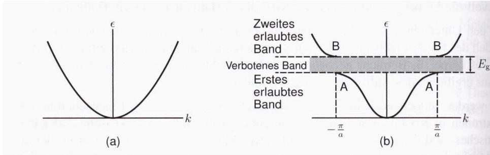
Abbildung 1: (a) Energie  $\epsilon$  in Abhängigkeit von der Wellenzahl  $k$  für ein freies Elektron. (b) Energie in Abhängigkeit von der Wellenzahl für ein Elektron in einem linearen monoatomaren Gitter der Gitterkonstanten  $a$ . Die eingezeichnete Energielücke  $E_g$  hängt mit der ersten Bragg-Reflexion bei  $k = \pm\pi/a$  zusammen; weitere Lücken treten bei  $\pm n\pi/a$  auf ( $n$  ist ganzzahlig).
