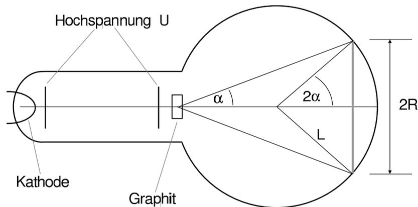
Folgendes Experiment weist durch die Beugung von Elektronen an einem Graphitkristall deren Wellencharakter nach. Die Gitterkonstanten des Graphit werden bestimmt.
